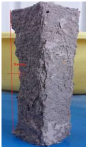
Figure IV.10: Dégradation d'une éprouvettes de SD2 50% après 100 cycles de gel-dégel.
