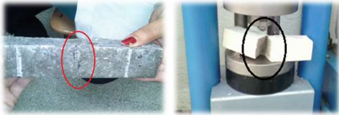
Figure III.19 : Mode de rupture d'une éprouvette à la flexion du BS avec et sans fibres.
