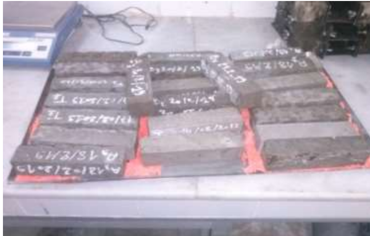
Figure II. 4 : Démoulage des éprouvettes
