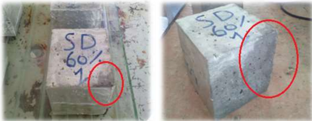
Figure III.11 : Eprouvettes soumises après l'essai de la porosité capillaire pour SD2 60%
